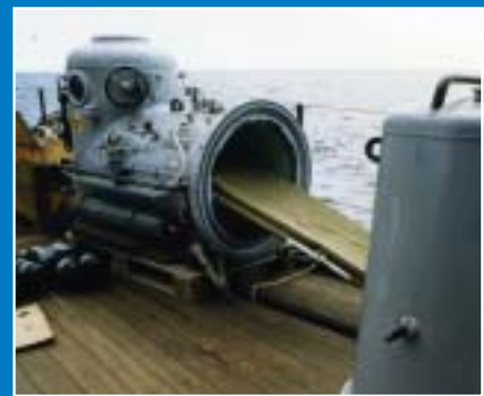
Om problem med dykaren skulle uppstå så fanns en transportabel tryckkammare att tillgå ombord på minutläggaren.
